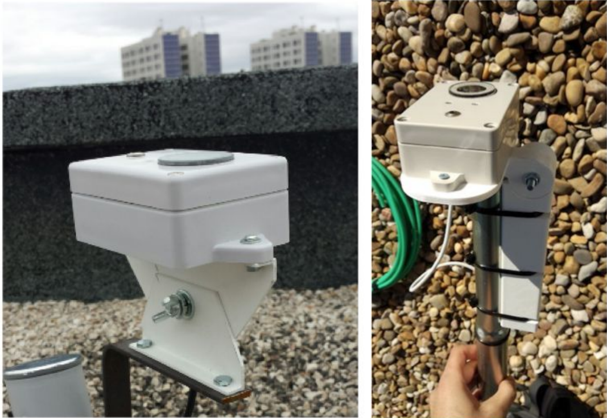
Figura 4 Posibles instalaciones para situar el fotómetro posición horizontal y así los sensores apunten hacia el cenit.
